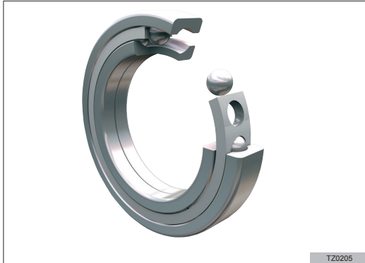
Rys.10 kulkowe, poprzeczne, skośne, 1-rzędowe, dwukierunkowe, z pierścieniem wewnętrznym dzielonym, typ QJ...
