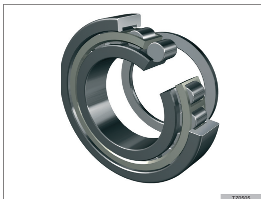
Rys.18b walcowe, poprzeczne, 1-rzędowe, ustalone osiowo dwustronnie - typ NUP..
